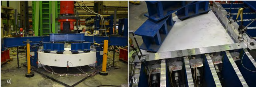
Bild 2: Versuchsstand Plattenviertel: a) Ansicht und b) Verankerung des Versuchskörpers an den Widerlagermodulen
