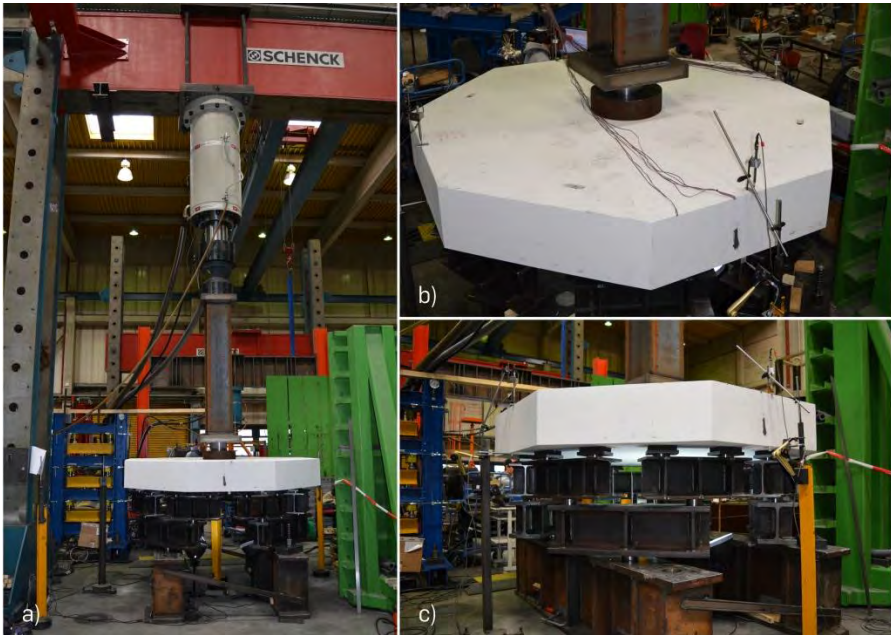
Bild 1: Versuchsaufbau Vollplatte: a) Ansicht, b) Lasteinleitung und c) Auflagerkonstruktion
