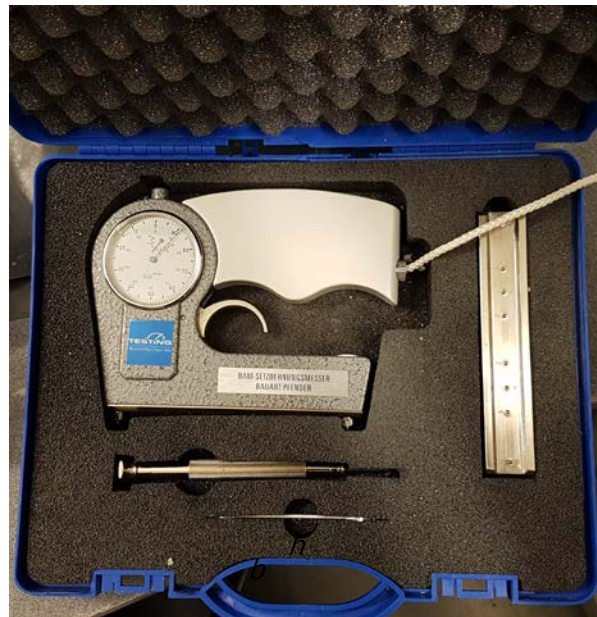
Setzdehnungsmesser vom Typ „Pfender“ im Koffer samt Zubehör
