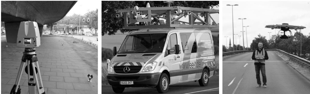
Abbildung 2: Eingesetzte stationäre und mobile Messverfahren: 3D-Laserscanning (links), Mobile Mapping (Mitte) [eagle eye technologies] und Hexacopterüberflug (rechts)
