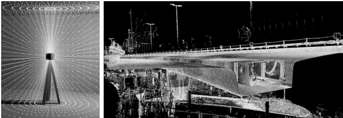
Abbildung 3: Rasterartige Erfassung von Oberflächen durch den 3D-Laserscanner (links) [9] und aus Einzelscans zusammengefügte Punktwolke (rechts)
