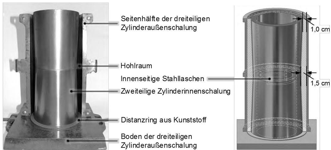
Abbildung 6: Schalungsaufbau des Hohlzylinders; links: Foto, rechts: Modell
